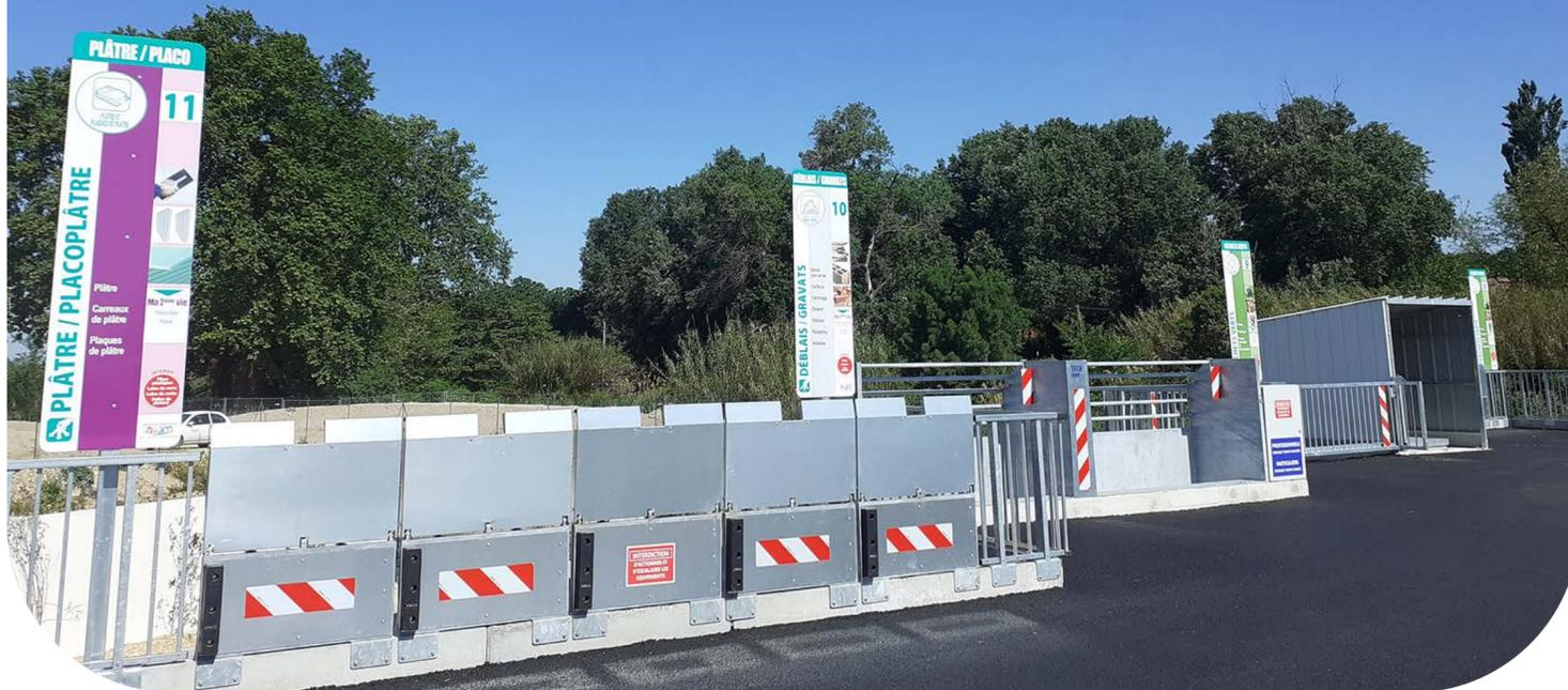
**Conformément aux obligations réglementaires, des garde-corps normalisés doivent être mis en place dès lors que la hauteur de risque de chute excède 1 mètre.**
